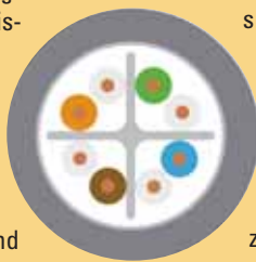
Schnitt durch ein Cat6-Kabel mit Abstandhalter zwischen den einzelnen Aderpaaren
